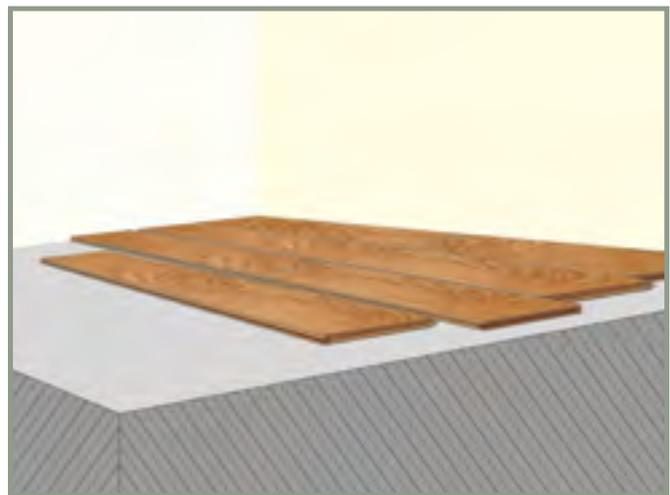
1. Vorbereitung/Unterbau: Der Untergrund muss fest, eben und trocken sein. Voranstrich mit einem vom Hersteller empfohlenen Primer zur Oberflächenverfestigung und als Feuchtigkeitssperre.
