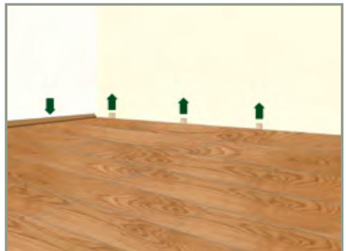
6. Sockelleiste anbringen: Nach der Verlegung die Keile entfernen und die Abstände zur Wand mit einer Sockelleiste abdecken.
