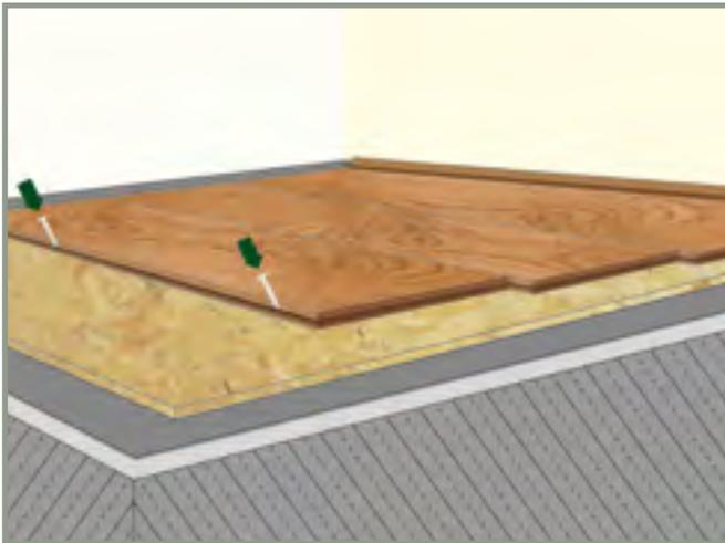
3. Verschrauben: Die folgenden Dielenreihen verdeckt durch die Feder mit speziellen Dielenschrauben verschrauben. Die letzte Dielenreihe wieder - wie die erste - von oben verschrauben.
