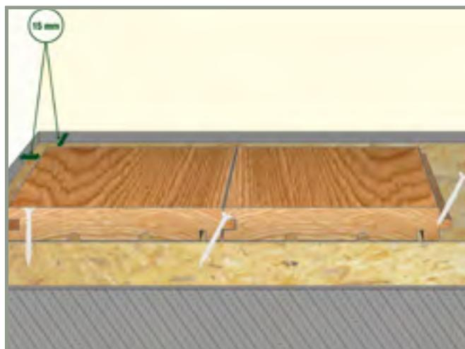
2. Unterkonstruktion 1: Verlegung auf schraubfesten Platten, z.B. OSB-Platten. Einhalten der Wandabstände von min. 15 mm. Die erste Dielenreihe mit der Nut zur Wand in der Flucht ausrichten und von oben auf die Platte verschrauben. Nach Verlegung der ersten und zweiten Dielenreihe die Flucht nach kontrollieren und ggf. nachbessern!
