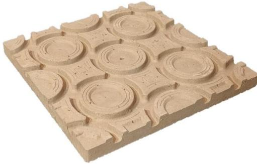
Hochleistungs-Lehmmodul mit Rillenmatrix zur kupplungsfreien, individuellen Rohrverlegung. Größe: 37,2 x 37,2 x 2,5cm, 1m<sup>2</sup>  $\cong$  7,23 Stück
