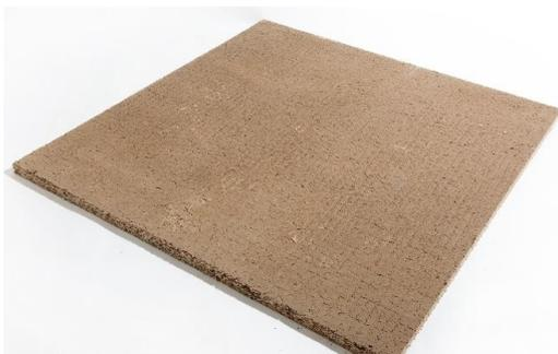
Lehm-Anschlussplatte als Putzträger für Gebäude mit Kühllasten < 45 Watt/m<sup>2</sup>, für die Rohrverteilm-/Rohranbindebereiche. Größe: 115 x 62,5 x 1,3cm Nach Bedarf zuschneiden!
