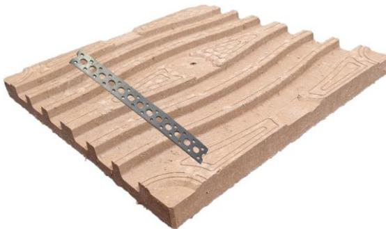
Hochleistungs-Rohranbindemodul für Gebäude mit Kühllasten > 45 Watt/m<sup>2</sup>, für bis zu sechs Heizkreisen, inklusive Edelstahl-Lochband zur Rohrfixierung. Größe: 37,2 x 37,2 x 2,5cm
